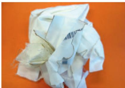
**Bild 7. PA6.6-Gewebe/Produktionsabfall aus der Airbag-Produktion**
