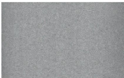
**Bild 4. Flachfolienmuster (Breite: 60 mm), hergestellt auf einem OCS Messextruder ME25/25D-V3; Material: 23 % hochgefülltes PP-Vlies/Talkum Rezyklat (Talkumgehalt 70 % Omya Talco SD 20) + 77 % PP-Homopolymer**
