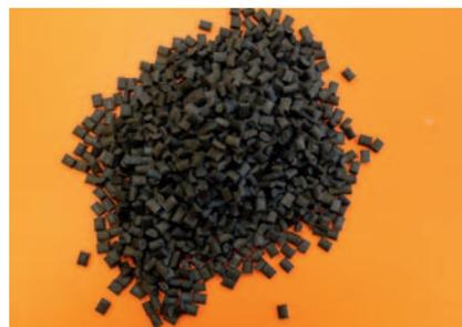
**Bild 8. PA6.6-Rezyklat mit 30 % Glasfaser und Masterbatch black aus PA6.6-Fasern und Airbag-Produktionsabfällen**
